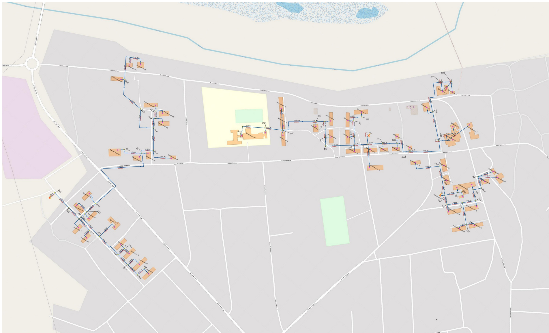
Рис.16 – Общий вид электронной модели системы теплоснабжения Котельных 1,2,7
